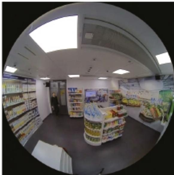
単一センサーカメラからの円形表示。カメラを天井に設置すると、部屋全体の完全なオーバービューを得ることができます(左)。カメラを壁面に設置すると、人物の顔を確認するのに適した角度でオーバービューを得ることができます(右)。
