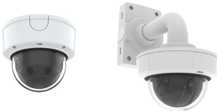
マルチセンサーパノラマカメラは、1つのケーシングに複数のセンサーとレンズを搭載しています。センサーからの個別の映像はわずかに重なり合っており、まとめて1つの詳細な180° パノラマオーバービューになるよう配置されます。
