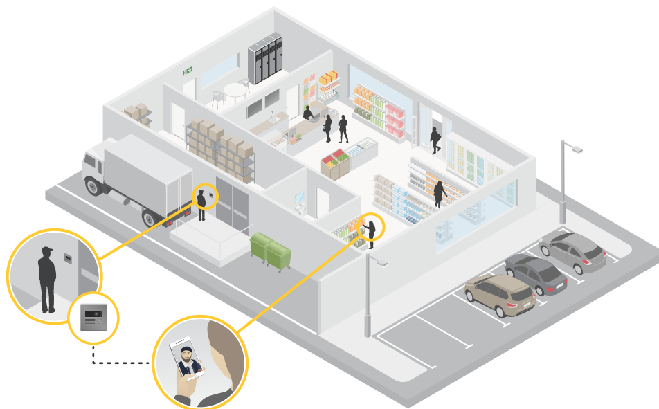
Figure 2. Uma implantação de segurança típica para uma empresa de pequeno ou médio porte. O intercomunicador com vídeo permite que os funcionários recebam mercadorias e destranquem portas para visitantes sem deixar os clientes desacompanhados.
