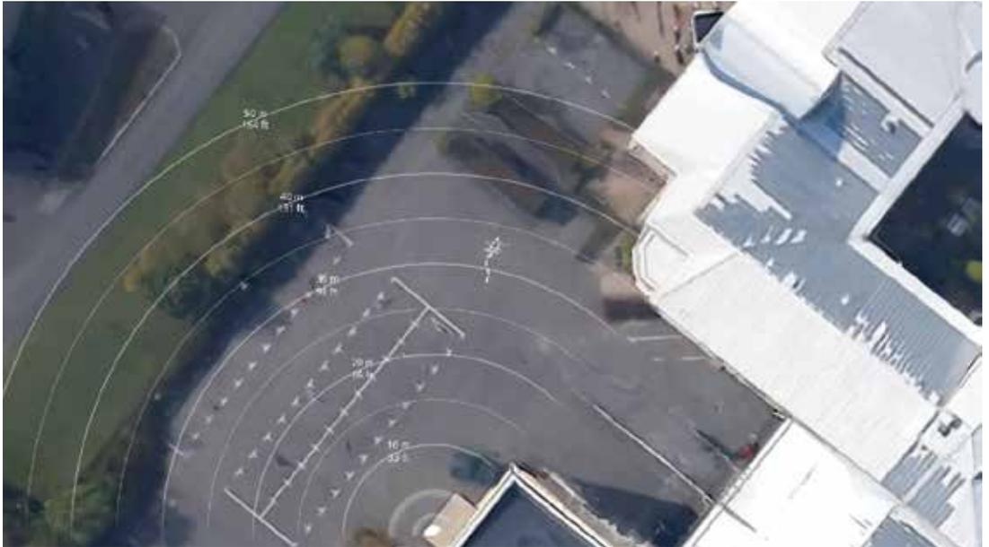
*Figura 2. Uma cena (vista de cima) monitorada pelo Radar IP AXIS D2050-VE, como mostrada na interface do usuário e combinada com o mapa de referência. O detector está instalado no edifício, na parte inferior da imagem. A seta logo acima do centro da imagem marca um objeto sendo rastreado pelo detector.*
