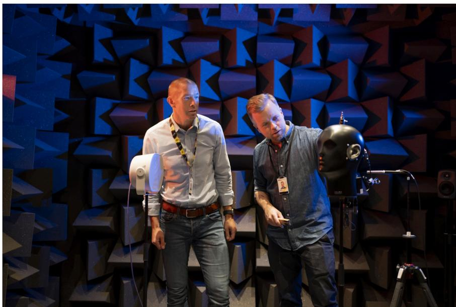
*Medições acústicas nos laboratórios de P&D da Axis*
