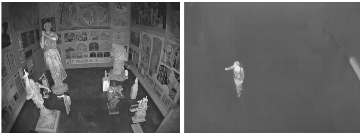
Figure 4. Images comparant la caméra jour/nuit et la caméra thermique, toutes deux capturées dans l'obscurité.
