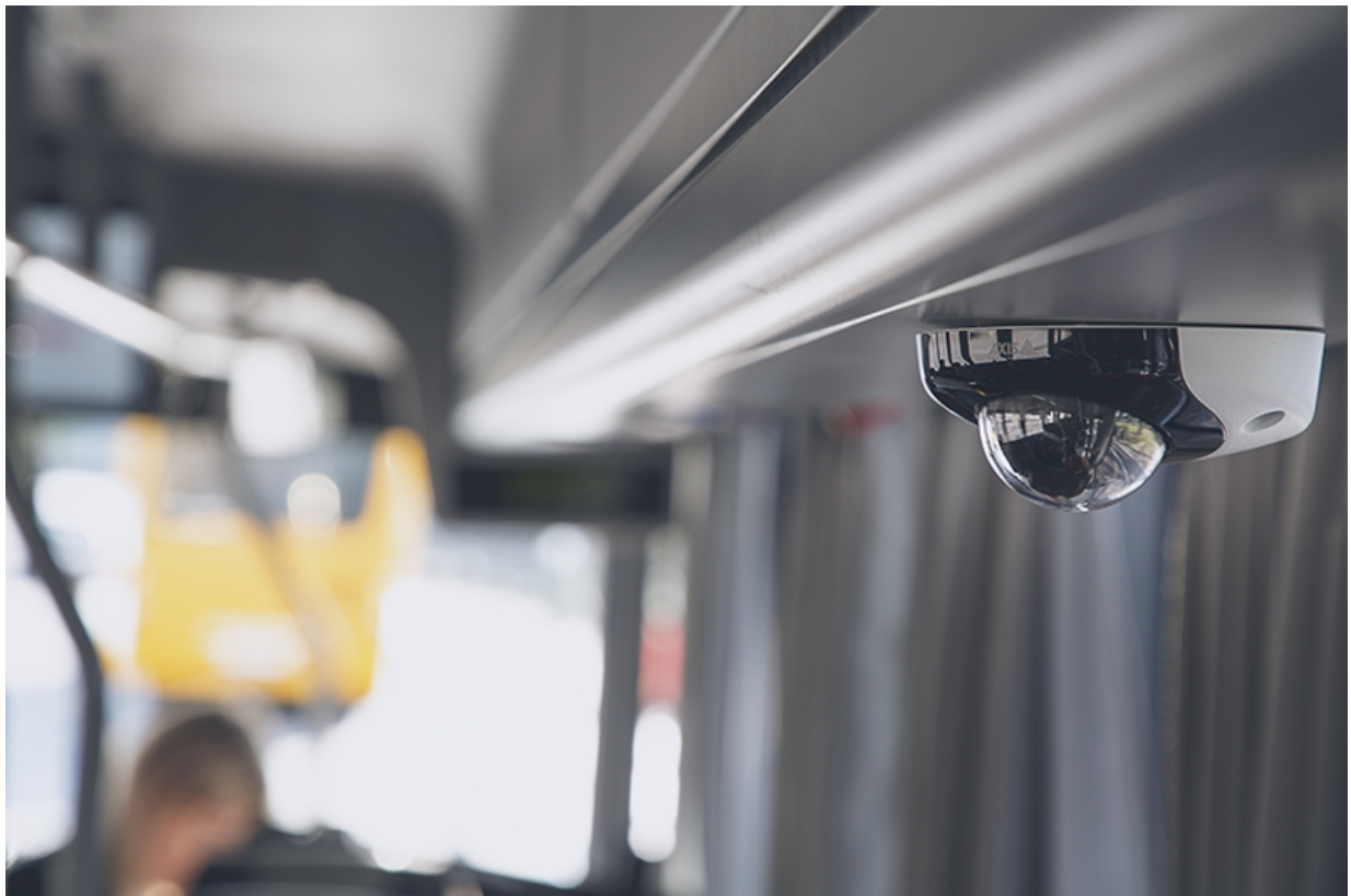
Uma câmera com edge storage em uma instalação a bordo.
