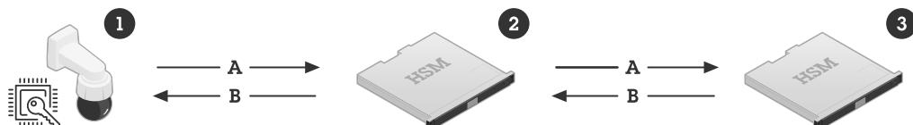
Figure 2. 製造工程でAxisデバイスIDを工場でプロビジョニングできるように、AxisはIEEE 802.1ARに準拠した公開鍵インフラストラクチャー（PKI）を実装しています。製品のシリアル番号が組み込まれた証明書であるAxisデバイスID(1)は、AxisデバイスID中間CA(2)によって署名され、この中間CAはAxisデバイスIDルートCA(3)によって署名され
