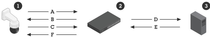
Figure 5. オンボーディングプロセスに関する詳細説明。安全なデバイスIDのIEEE 802.1ARには、RADIUSサーバー(3)を使用して、IEEE 802.1X EAP要求(EAP-TLS)経由でデバイス(1)を識別し、ネットワークへのデバイスアクセスを許可する方法が定義されています。
