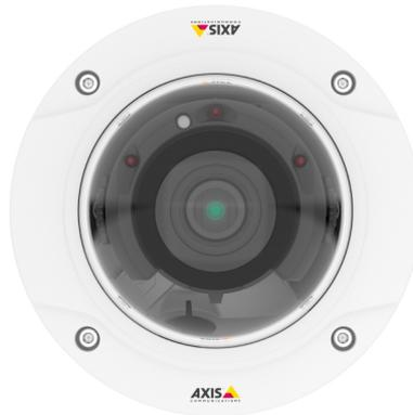
*Uma câmera dome com três luzes de LED IR dentro do dome.*
