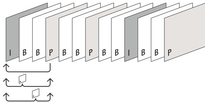
Figure 2.1. I, B, Pフレームを含む一般的なシーケンスの例。Pフレームは、先行するIフレームまたはPフレームだけを参照するのに対し、Bフレームは、その前後のIフレームまたはPフレームを参照する場合があります。ストレージプロファイルでは、Bフレームの数が動的に変更されます。
