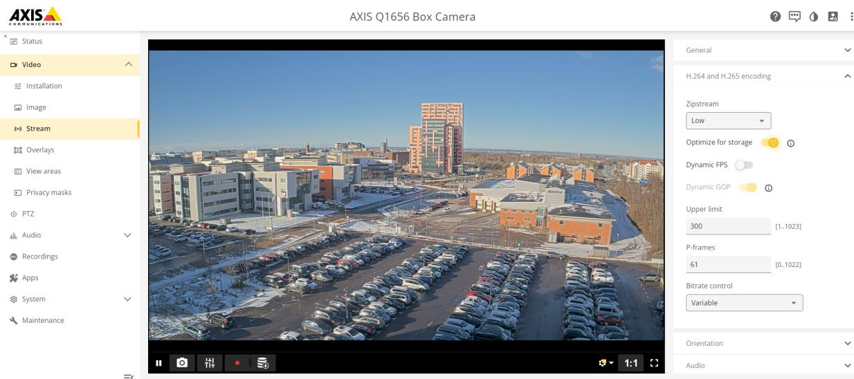
Figure 1. カメラのGUIのZipstream設定で[Optimize for storage (ストレージ用に最適化)]を選択し、ストレージプロファイルを有効にします。
