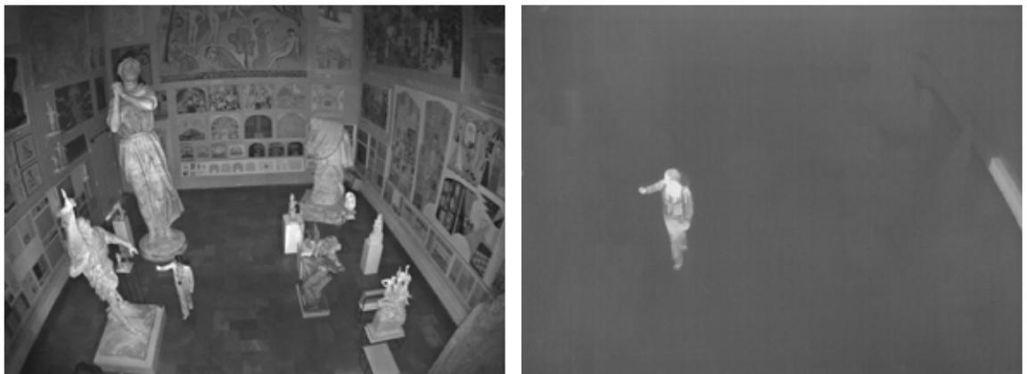
Abb. 4 und 5: Das Bild links zeigt eine Tag- und Nacht-Kamera mit integrierter Infrarot-Beleuchtung, rechts ist ein Bild von einer Wärmebildkamera zu sehen, die Wärmestrahlung passiv detektiert.
