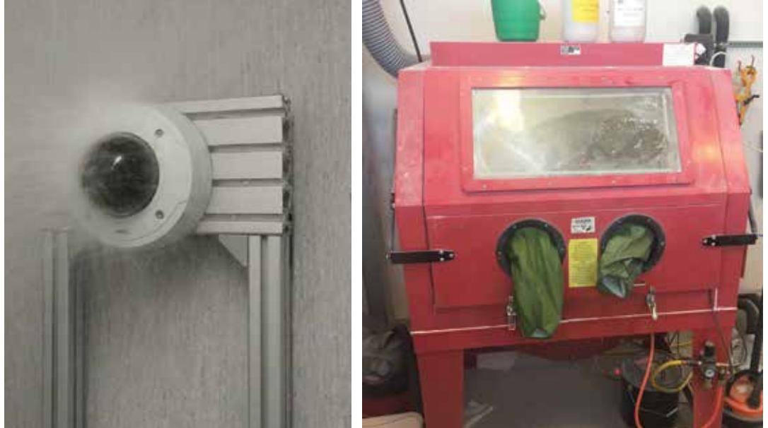
Abbildung 3: Links: Prüfung einer Kamera auf Wasserdichtigkeit. Rechts: Staublabor.
