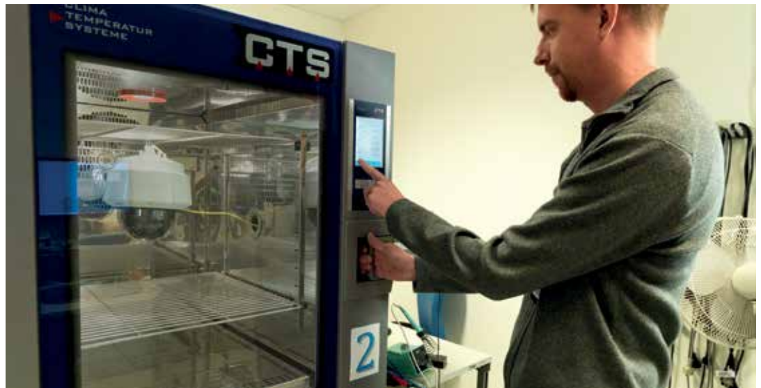
Abbildung 5: Temperaturtest in einer Klimakammer.
