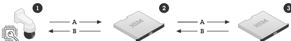
Figure 2. Infraestrutura de chave pública (PKI) IEEE 802.1AR da Axis, para provisionamento de fábrica da ID do dispositivo Axis durante o processo de manufatura. A ID do dispositivo Axis (1), que é um certificado que incorpora o número de série do produto, é assinada por uma ID do dispositivo Axis intermediária CA (2), que foi assinada pela raiz CA da ID do dispositivo Axis (3). Módulos de segurança de hardware (HSM) dedicados são usados para provisionamento seguro de fábrica.
