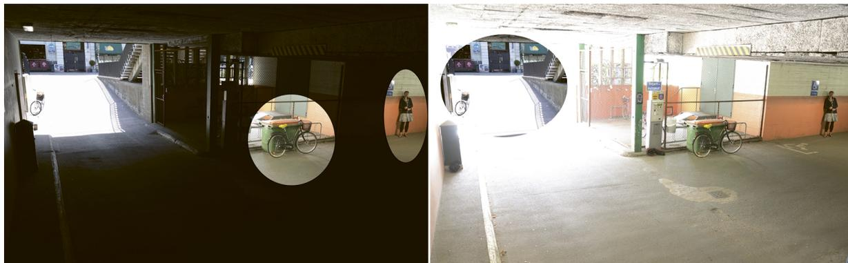
Figure 2. Même scène que précédemment. L'image de gauche contient des détails non révélés avec le temps d'exposition court. L'image de droite contient des détails non révélés avec le temps d'exposition long.
