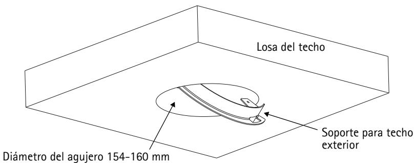
5. Pase todos los cables necesarios (cable de red, cable de alimentación, etc.) y el cable de seguridad por el orificio hasta dejarlos preparados para las conexiones.
