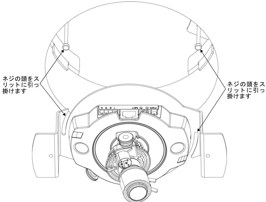
11. アウターブラケットのネジ (M3x60) をゆっくりと回しながら、天井をアウターブラケットとインナーブラケットの間に挟むようにして固定します。ケーブル類がブラケットに引っ掛かっていないことを確認してください。
