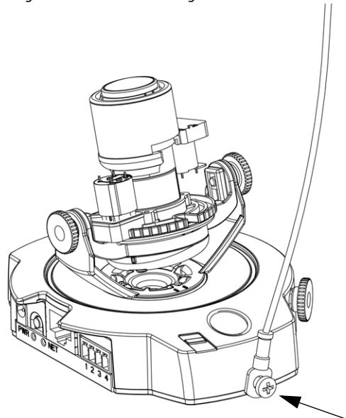
8. Befestigen Sie die Kamera wie dargestellt mit den beiden M4x10-Schrauben an der inneren Deckenhalterung. Ziehen Sie die Schrauben nicht zu fest, da dies zu einer Beschädigung der Kamera führen kann.
