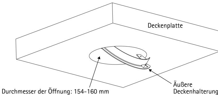
5. Ziehen Sie die benötigten Kabel (Netzwerk, Strom usw.) sowie das Sicherungskabel durch die Öffnung, so dass sie direkt angeschlossen werden können.
