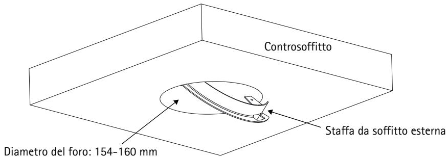
5. Passare tutti i cavi (rete, alimentazione e così via), compreso il cavo di sicurezza, attraverso il foro, pronti per la connessione.
