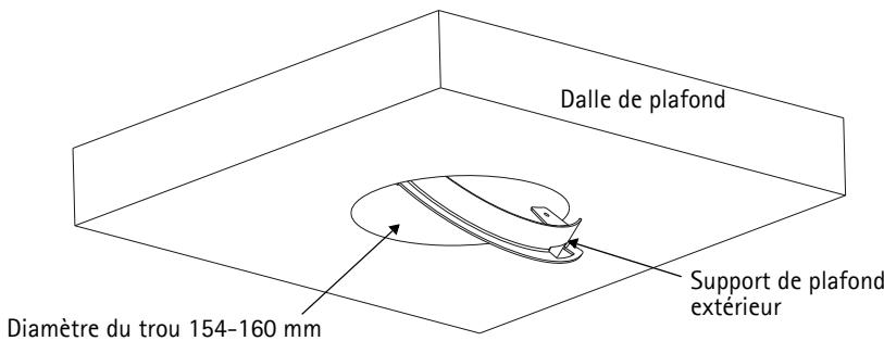
5. Faites descendre par le trou l'ensemble des câbles requis (réseau, alimentation, etc.) ainsi que le fil de sécurité. Le raccordement est alors possible.
