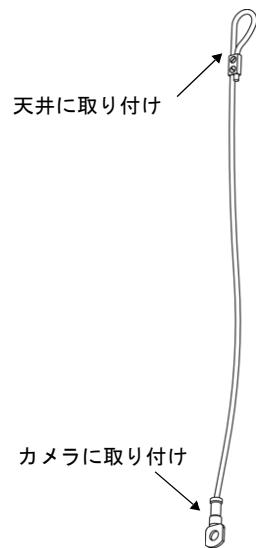
**注意：** ネットワークカメラとブラケットを合わせた総重量は約0.82kgになります。天井の素材がこの重量に耐えられることを事前に確認してください。ブラケットの取り付けが可能な天井の厚さは、9 ~ 60mm です。
