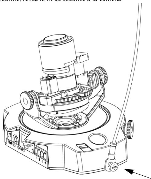
8. À l'aide des 2 vis M4x10 fournies, montez la caméra sur le support de plafond intérieur, comme illustré ci-dessous. Ne serrez pas trop les vis car vous risqueriez d'endommager la caméra.
