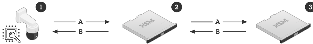
Figure 5. La infraestructura de clave pública (PKI) IEEE 802.1AR de Axis para el aprovisionamiento en fábrica del ID de dispositivo de Axis durante el proceso de fabricación. El ID del dispositivo Axis (1), que es un certificado que incorpora el número de serie del producto, está firmado por una CA intermedia del ID del dispositivo Axis (2), firmado por la CA raíz del ID del dispositivo Axis (3). Para el aprovisionamiento en fábrica seguro se utilizan módulos de seguridad de hardware (HSM) específicos.
