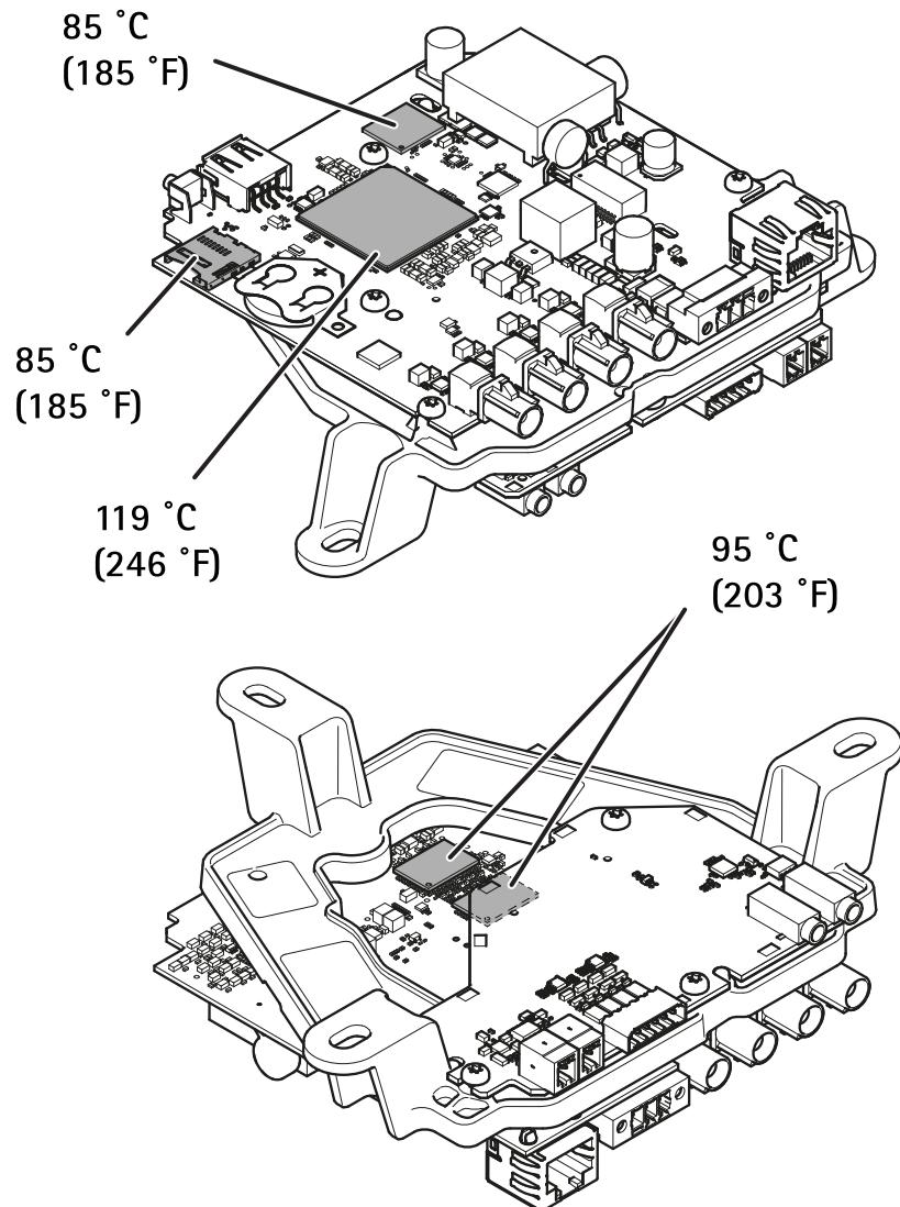
最大許容温度。周囲温度が $35^{\circ}\text{C}$ 以上の場合は、コンポーネントの温度が上昇するため、コンポーネントを冷却する必要があります。
