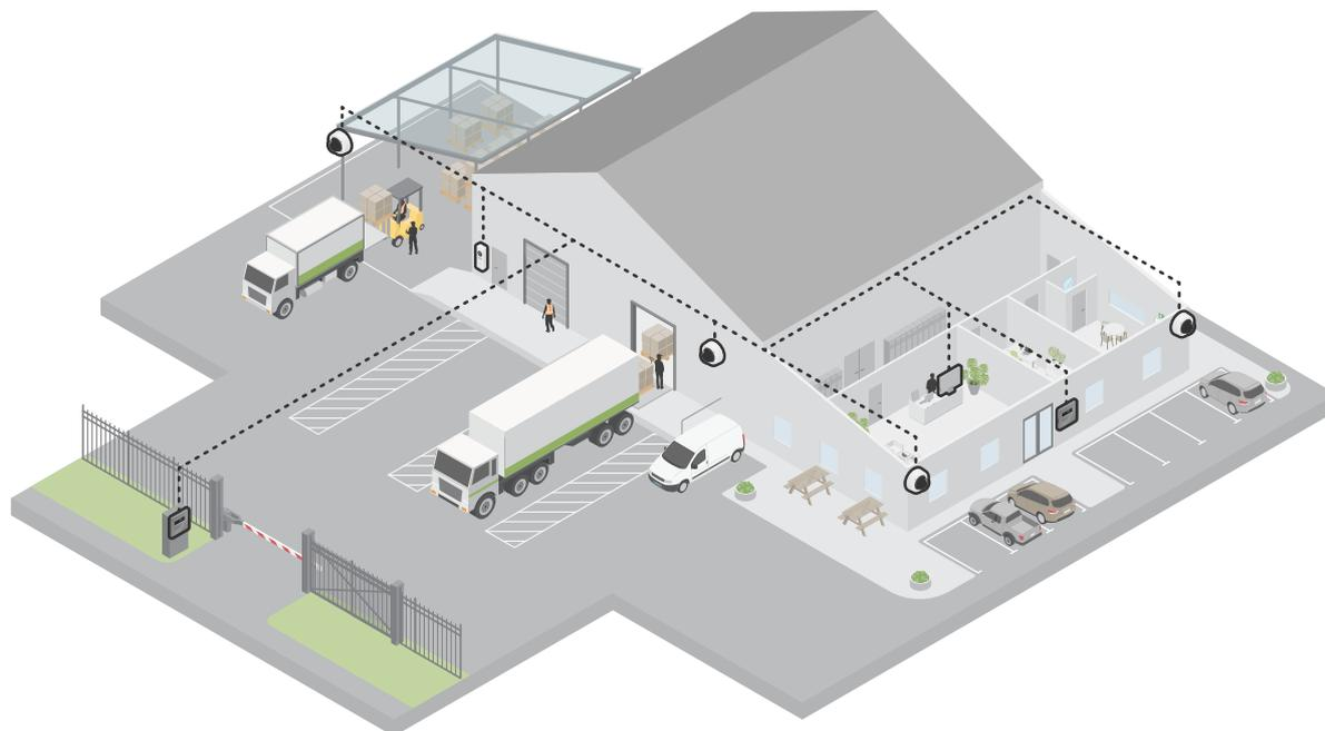
*Figure 3. Dans les grands systèmes, par exemple dans les centres logistiques ou les aéroports, les visiophones complètent efficacement toute solution intégrée comprenant des caméras de surveillance réseau, des systèmes de contrôle d'accès, des alarmes anti-intrusion et d'autres applications de sécurité.*
