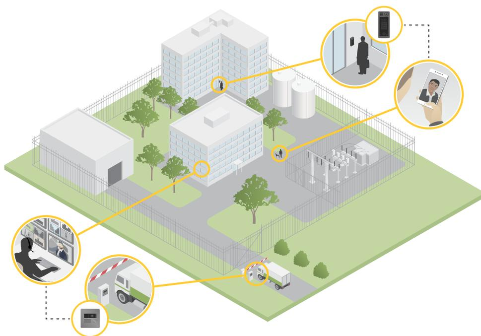
*Figure 1. Implanté à l'entrée d'un site, un visiophone est connectable à plusieurs stations de réception. Néanmoins, dans une perspective de surveillance, il est beaucoup plus efficace et utile de l'associer à des caméras réseau et d'autres dispositifs IP, tous connectés à un même poste centralisé.*
