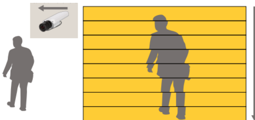
Figure 2. Das Prinzip der Rolling-Shutter-Verzerrung: Der Sensor liest das Bild zeilenweise von oben nach unten. Wenn sich die Kamera aufgrund von Vibrationen leicht nach links bewegt, während die Zeilen ausgelesen werden, wird das Bild verzerrt.
