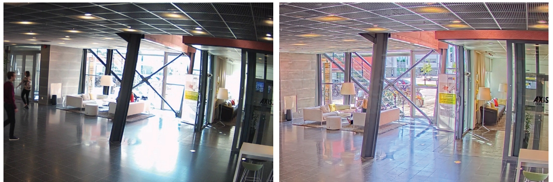
Figuras 5 e 6: cena em um ambiente interno com iluminação de fundo intensa. Comparação entre uma câmera de rede convencional sem o recurso WDR (esquerda) e uma câmera Axis com WDR Forense (direita).
