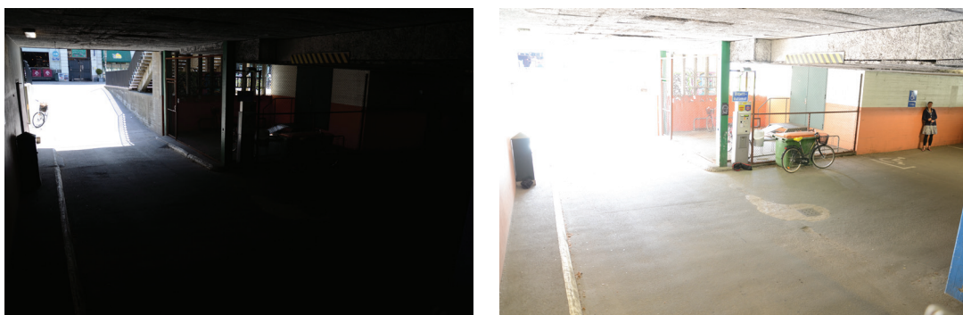
Figuras 1 e 2: uma cena de vigilância com amplo alcance dinâmico típica: o interior de um estacionamento e sua entrada. As duas imagens foram geradas usando diferentes tempos de exposição, menor na imagem à esquerda e maior na imagem à direita.
