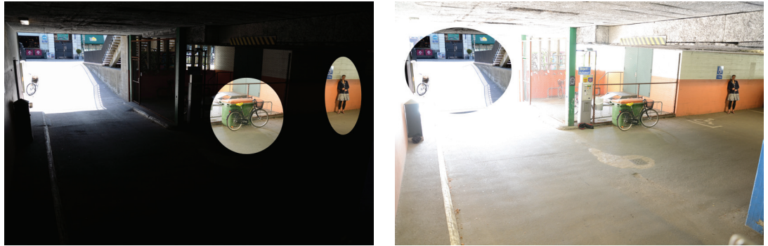
Figuras 3 e 4: a mesma cena anterior. A imagem à esquerda mostra detalhes que foram perdidos com o tempo de exposição curto. A imagem à direita mostra os detalhes que foram perdidos com o tempo de exposição longo.
