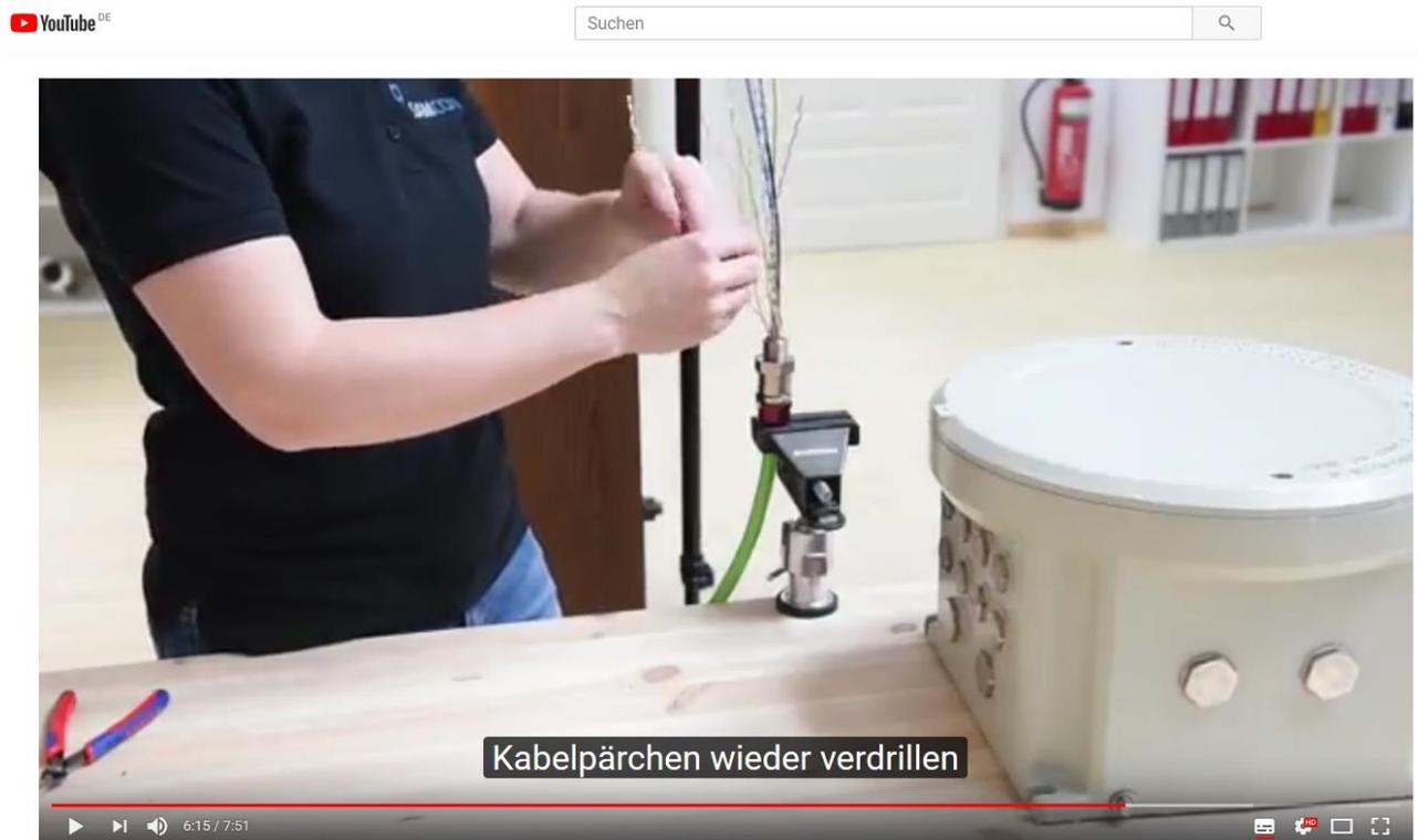
Bild 5-8 Ex-d Barriereverschraubung
