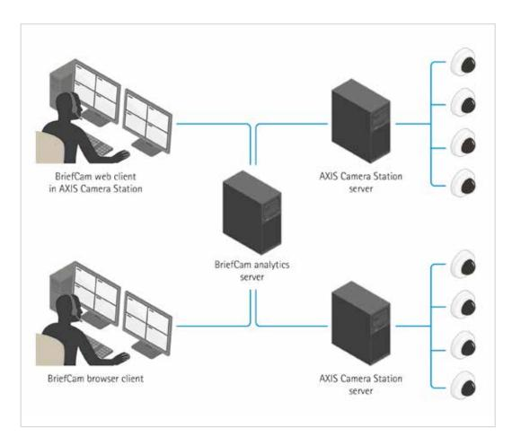
Für jeden Standort einer AXIS Camera Station wird ein BriefCam Server benötigt. Mehrere AXIS Camera Station Server können angeschlossen werden.
