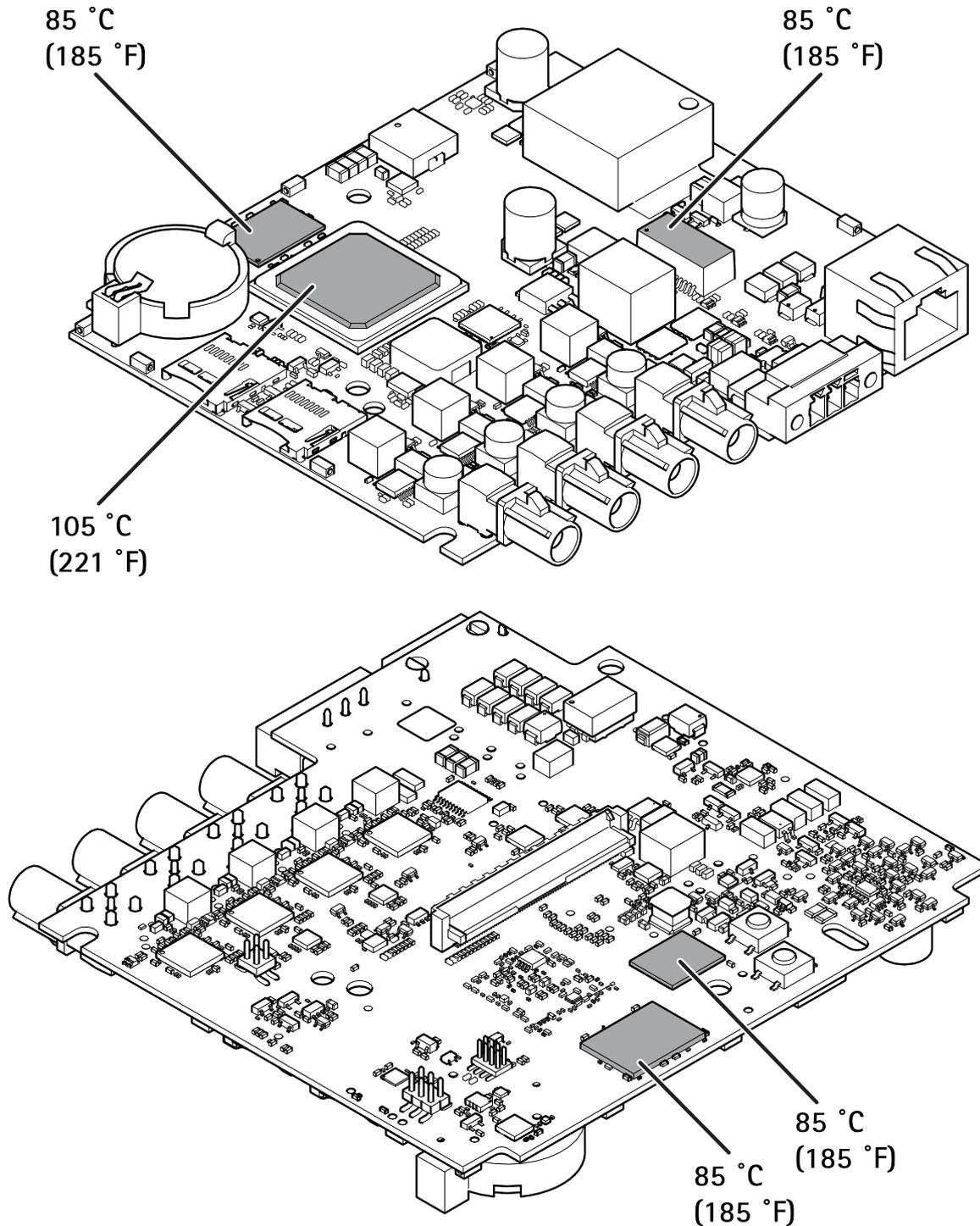
*Temperaturas máximas permitidas. Si la temperatura ambiente es de 35 °C o superior, aumenta la temperatura de los componentes, que deben refrigerarse.*
