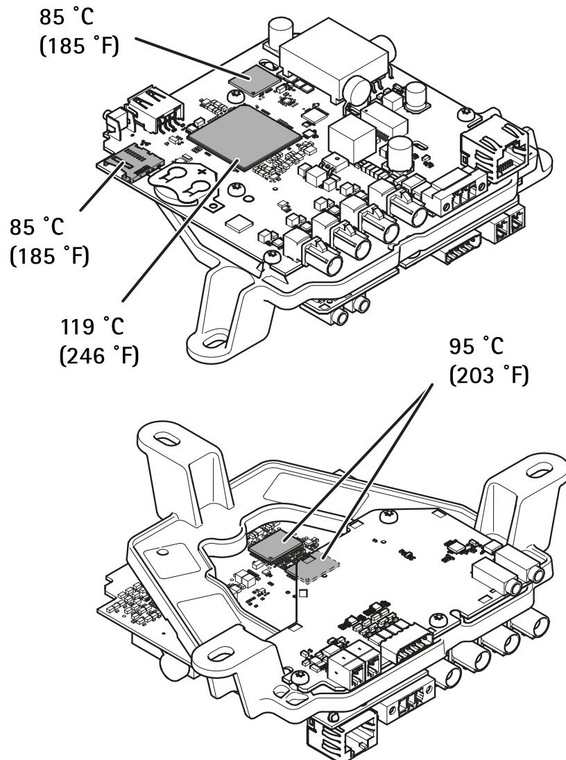
최대 허용 온도. 주변 온도가  $35^{\circ}\text{C}$ ( $95^{\circ}\text{F}$ ) 이상이면 구성 요소의 온도가 올라가므로 냉각해야 합니다.
