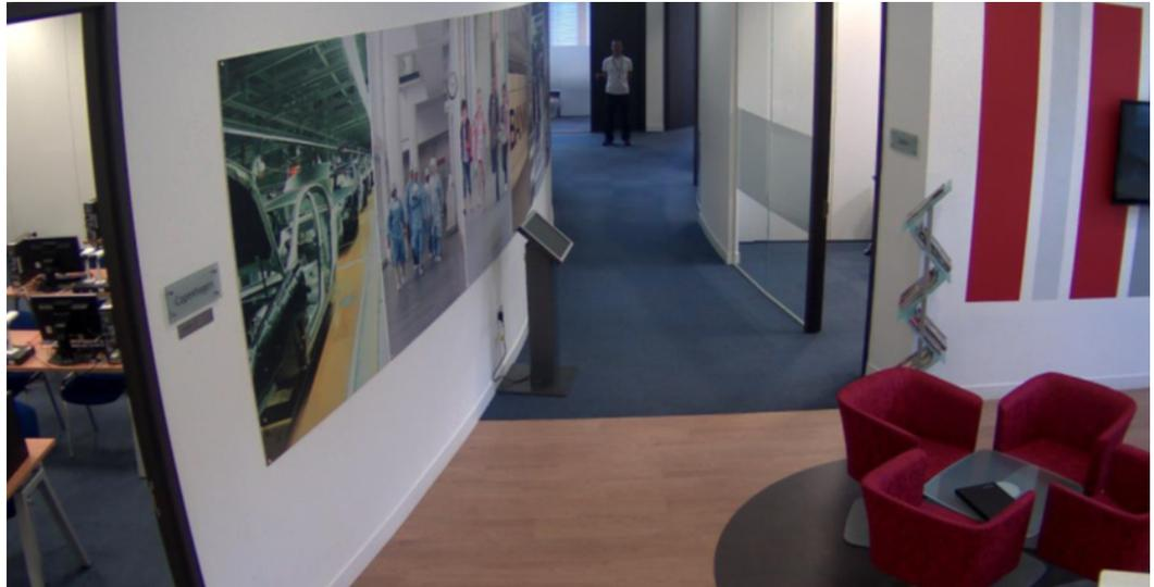
La seguente immagine è invece rappresentata con Axis Corridor Format. Il sensore della telecamera è ruotato fisicamente di 90° e l'immagine è controruotata elettronicamente per garantire il corretto orientamento per la visualizzazione. L'immagine viene rimessa a fuoco per corrispondere alla vista in alto e in basso dell'immagine 16:9 originale, determinando una maggiore densità pixel nell'area di interesse.
