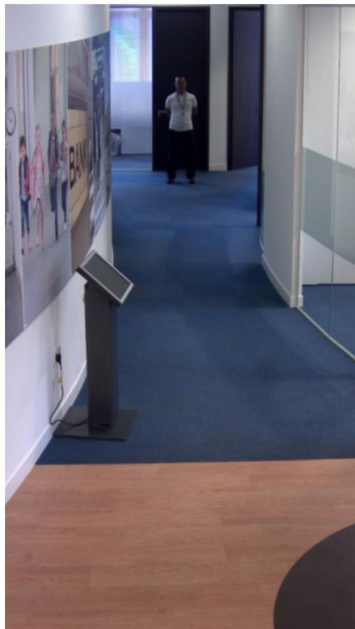
Il seguente confronto dimostra che, ingrandendo digitalmente l'immagine con Axis Corridor Format, si ottiene una migliore qualità e il riconoscimento diventa possibile dove prima non lo era. Questo risultato è stato ottenuto con la stessa telecamera. Senza aumentare i costi, viene generata un'immagine migliore e più utilizzabile.
