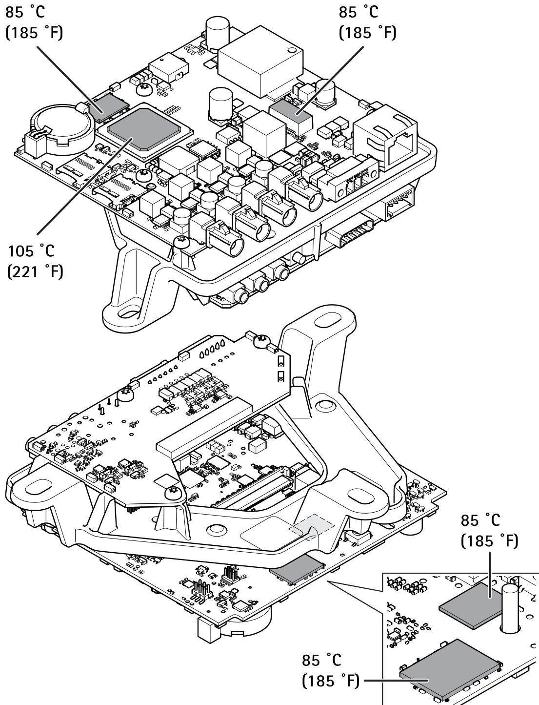
Temperaturas máximas permitidas. Si la temperatura ambiente es de 35 °C o superior, aumenta la temperatura de los componentes, que deben refrigerarse.
