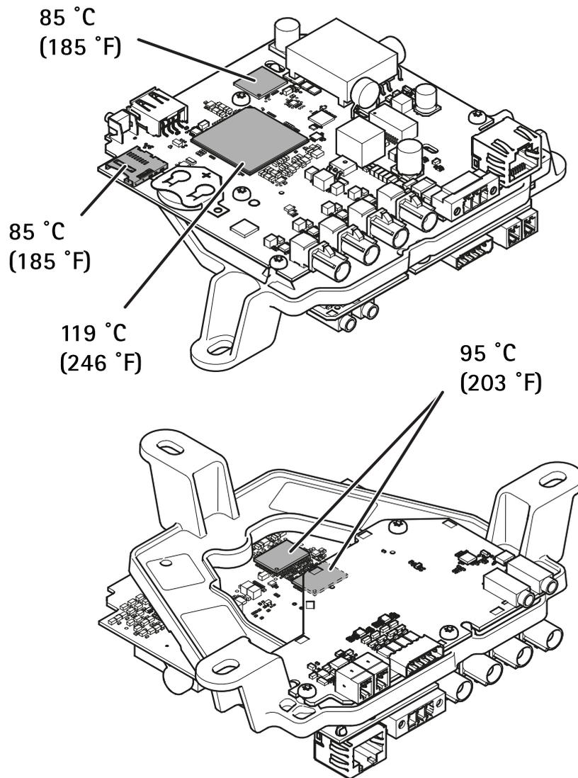
**Maximal zulässige Temperaturen. Wenn die Umgebungstemperatur 35 °C (95 °F) oder höher beträgt, steigt die Temperatur der Komponenten und sie müssen gekühlt werden.**
