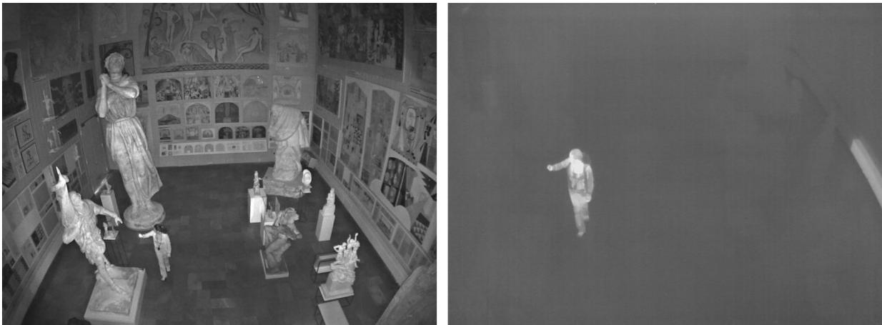
Figure 4. Bilder zum Vergleich von einer Tag-und-Nacht-Kamera und einer Wärmebildkamera, die beide bei Dunkelheit aufgenommen wurden.
