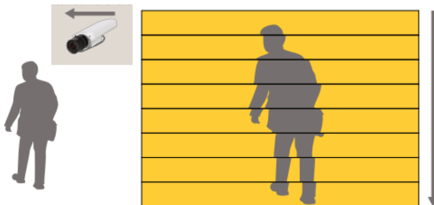
Figure 2. ローリングシャッターの歪みの原理。画像の上から下に向かってラインごとにスキャンされます。ラインがスキャンされている間に振動によってカメラがわずかに左に動くと、画像が歪んでしまいます。
