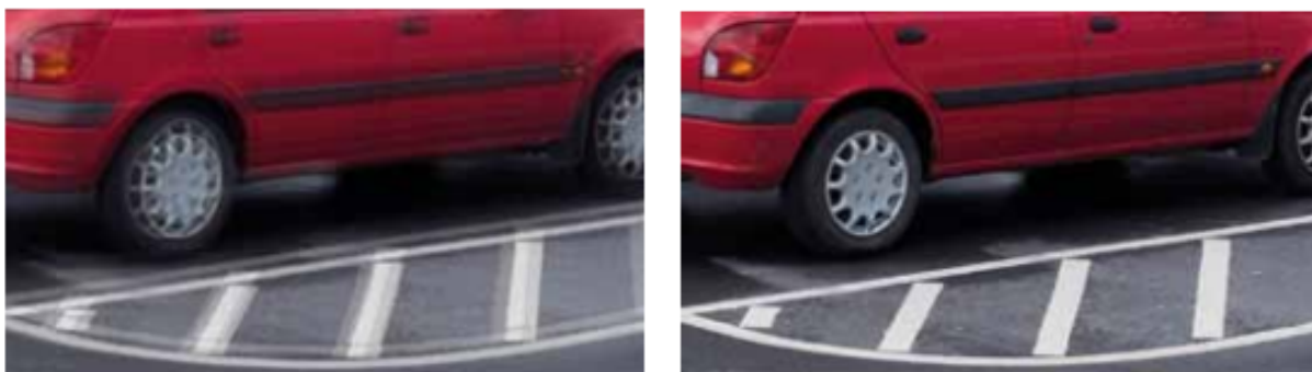
Figure 1. シミュレート画像。左：電子動体ブレ補正なしのクローズアップ。水平方向と垂直方向の両方にブレが見られます。右：振動しているカメラで電子動体ブレ補正を有効にして撮影したスナップショット。
