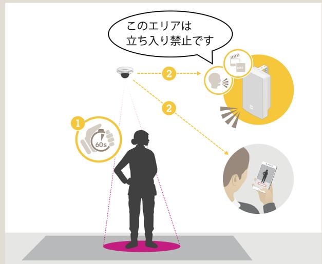
指定したエリアでのうろつきを検出することで、侵入の可能性がある人物の行動を抑止します。滞留時間をトリガーに (①)、事前に録音したメッセージをスピーカーから再生したり (②)、スタッフへメッセージを送信して現場の状況をモバイルで確認することができます (②)。
