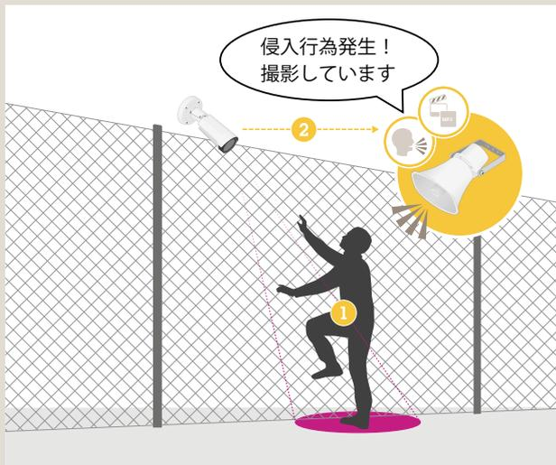
侵入者がフェンスを乗り越えようとする時 (①)、カメラは音声システムを使用して自動的に警告を出します (②)。また同時に、警備員にアラートを出すことができます。
