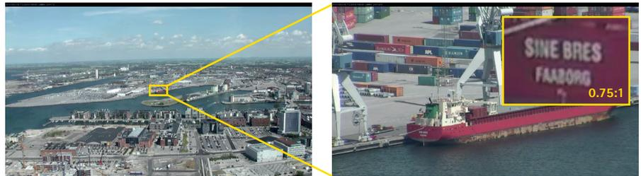
Mit der AXIS Q6035/-E ist es möglich Schriften aus einer Distanz von bis zu 1,6 km zu lesen. Links ein Bild mit Weitwinkel in 1080p, rechts ein Bild mit 20-fachem optischen Zoom auf den Schriftzug eines Containerschiffes.
