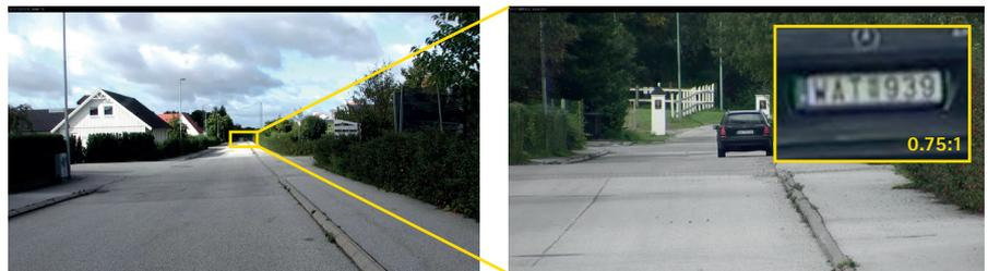
Mit der AXIS Q6035/-E ist es möglich Kennzeichen in einer Distanz von bis zu 275 m zu lesen. Links ein Bild mit Weitwinkel in 1080p, rechts ein Bild mit 20-fachem optischen Zoom auf ein KFZ mit herangezoomten Nummernschild.
