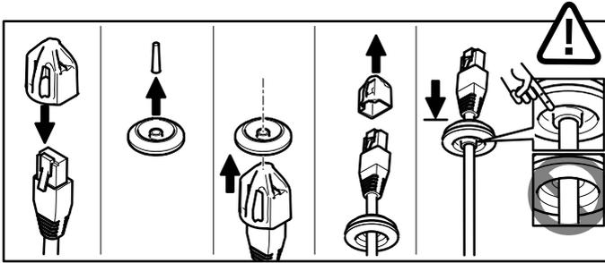
4. Puxe o cabo de rede ligeiramente para trás de modo que a gaxeta do cabo se ajuste no cabo.
