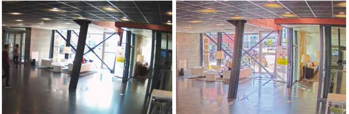
图 5 和图 6: 强背光下的室内场景。不支持 WDR 功能的传统网络摄像机 (左图) 与安讯士 Forensic WDR 摄像机 (右图) 的对比。
