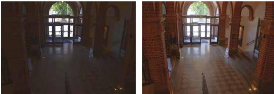
图 7 和图 8: 用具有不同 dB 值的摄像机拍摄的背光内部场景。出乎意料, 拍摄右图使用的摄像机的 dB 规格值小于左图所用的摄像机。
