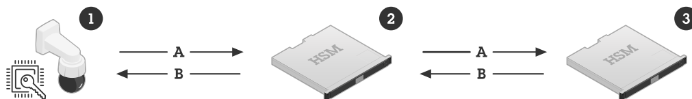
Figure 5. Infrastruktura kluczy publicznych (PKI) IEEE 802.1AR Axis na potrzeby fabrycznego przypisywania identyfikatorów urządzeń Axis podczas produkcji. Identyfikator urządzenia Axis (1), który jest certyfikatem zawierającym numer seryjny produktu, jest podpisany przez pośredniczący urząd certyfikacji identyfikatorów urządzeń Axis (2), który z kolei jest podpisany przez główny urząd certyfikacji identyfikatorów urządzeń Axis (3). Do bezpiecznego fabrycznego przypisywania identyfikatorów są używane specjalne sprzętowe moduły zabezpieczeń.
