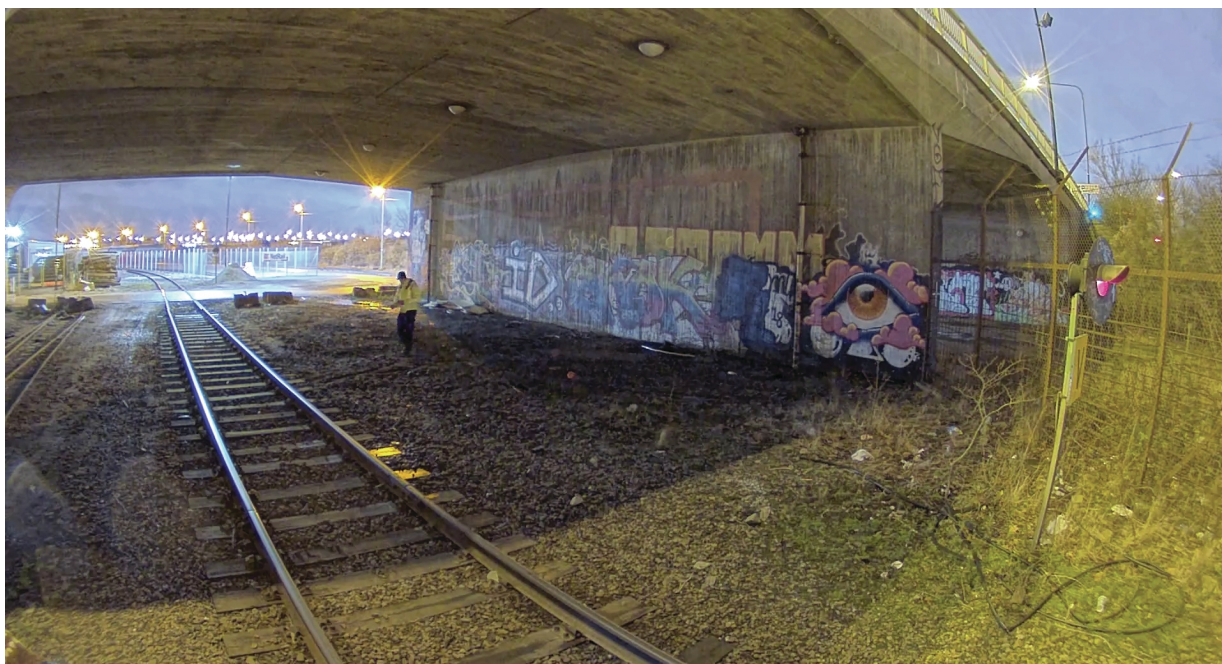
Figure 9. Image nette, vive et colorée produite par une caméra Lightfinder 2.0, malgré une intensité lumineuse de seulement 0,05 lux sous le pont.
