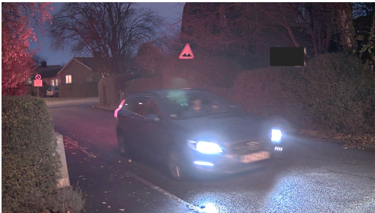
Figure 8. Une durée d'exposition longue peut engendrer un flou de mouvement visible. Dans cette capture, la plaque d'immatriculation aurait été lisible avec une durée d'exposition plus courte.
