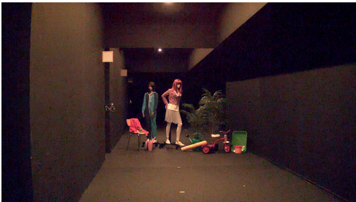
Figure 6. 0,1 lux – 0,3 lux mesuré sur les objets. La caméra Lightfinder produit une image en couleur moins nette, mais toujours très détaillée. L'œil humain ne discerne pas les surfaces plus sombres et ne distingue ni les détails, ni les couleurs.
