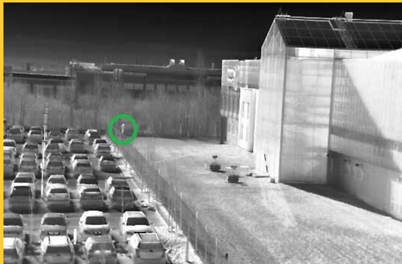
녹색 원은 사람의 존재를 나타냅니다. 비주얼 이미지에는 사람이 보이지 않습니다. 열상 이미지에는 사람이 보입니다.
