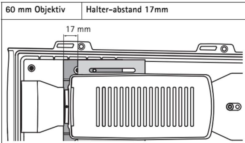
Note: Messen Sie den Halterabstand an beiden Seiten der Kamera, um sicherzustellen, dass die Kamera parallel zu den Haltern montiert wird.
