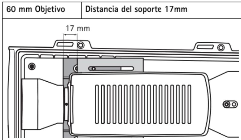
Note: Mida la distancia de los soportes a ambos lados de la cámara para asegurarse de que la cámara y los soportes están montados en paralelo entre sí.
