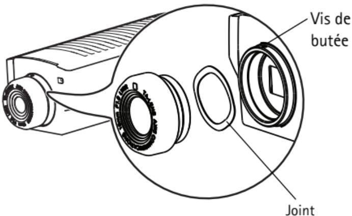
3. Dévissez l'objectif en tournant ce dernier dans le sens inverse des aiguilles d'une montre.
