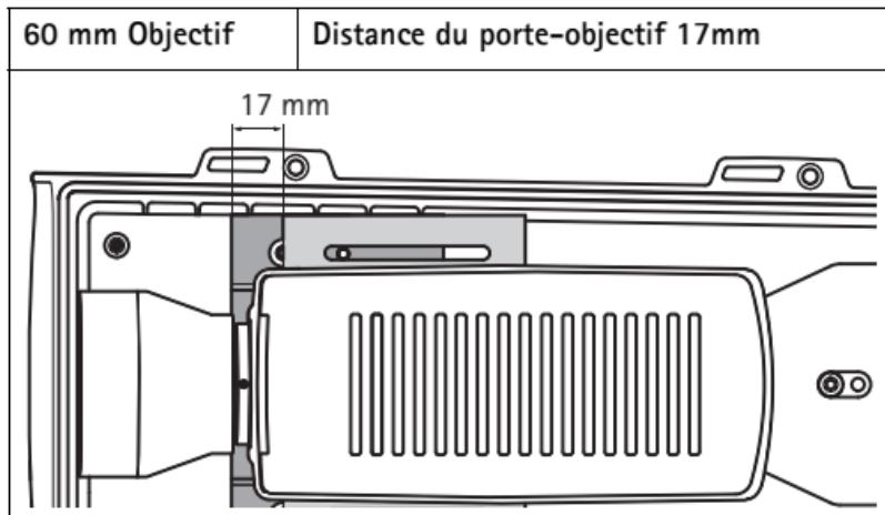
Note: Mesurez la distance du porte-objectif des deux côtés de la caméra afin de vous assurer que la caméra et les porte-objectifs soient montés parallèlement.
