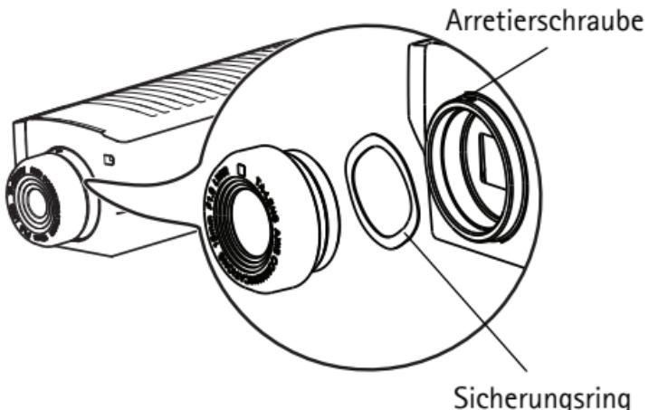
3. Schrauben Sie das Objektiv ab, indem Sie es gegen den Uhrzeigersinn drehen.
