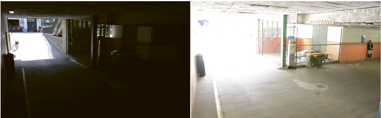
Ilustracja 2.1 Typowa scena objęta dozorem, w której występuje szeroki zakres dynamiki: wnętrze zadaszonego parkingu z wjazdem. Przedstawione dwa obrazy zostały zarejestrowane przy użyciu różnych czasów ekspozycji: krótszego w przypadku obrazu po lewej i dłuższego w przypadku obrazu po prawej stronie.
