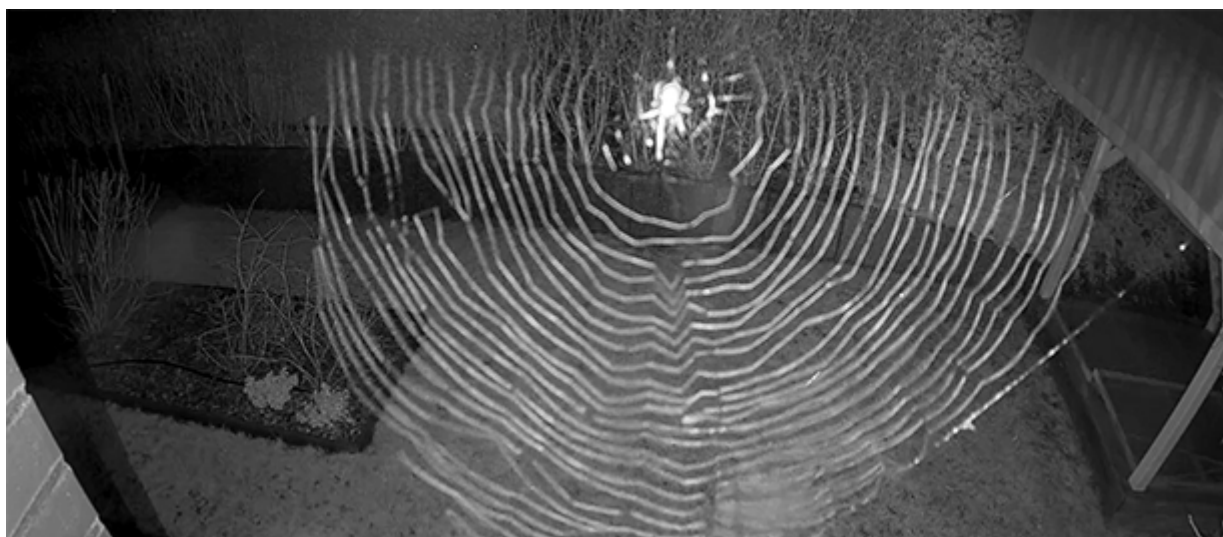
Pajęczyna może ograniczyć pole widzenia kamery dozorowej.
