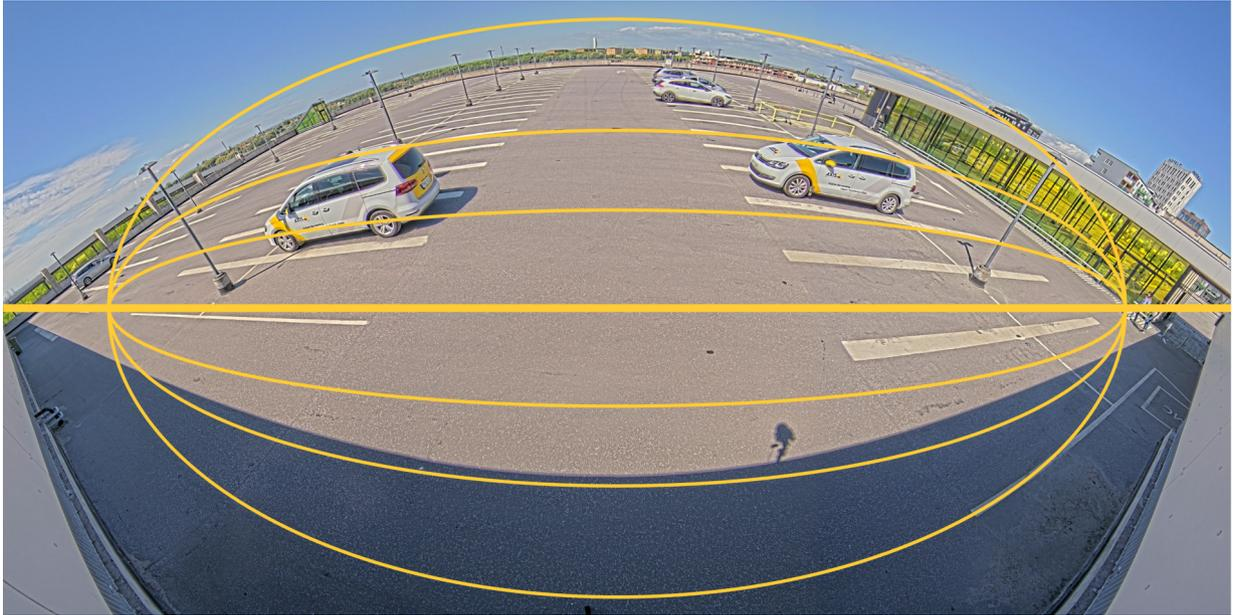
수평선 직선화를 적용하지 않고 멀티 센서 카메라로 촬영한 180도 파노라마 보기 스냅샷. 이미지에 추가된 선은 광각 멀티 센서 출력이 하나의 직사각형 이미지를 생성하기 위해 어떻게 투사되었는지에 대한 단서를 제공합니다. 보기의 수평 및 수직 중심을 제외하고 모든 선이 구부러지거나 기울어져 표시됩니다.
