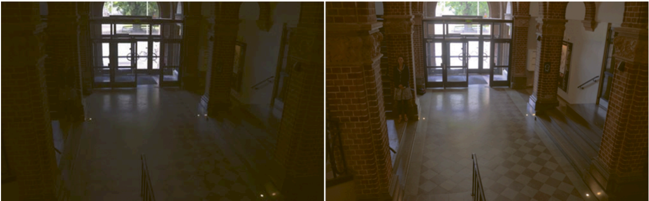
Abbildung 6.1 Von hinten beleuchteter Innenraum, erfasst von Kameras mit unterschiedlichem dB-Wert. Wider Erwarten stammt das rechte Bild von einer Kamera, deren angegebener dB-Wert geringer war als bei der linken Kamera.
