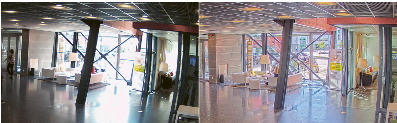
Abbildung 5.1 Innenraumszene mit starker Hintergrundbeleuchtung. Vergleich zwischen einer Kamera ohne WDR-Funktion (links) und einer Axis-Kamera mit Forensic WDR (rechts).
