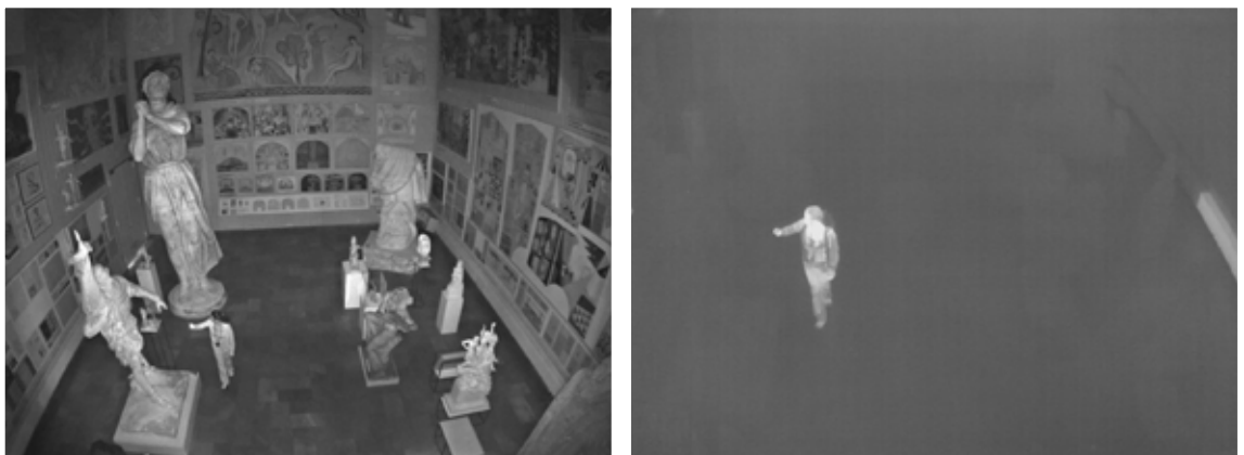
Figuras 4 e 5: à esquerda, uma imagem de uma câmera dia e noite com iluminação IV integrada, e à direita, uma imagem de uma câmera térmica detectando passivamente a radiação de calor.
