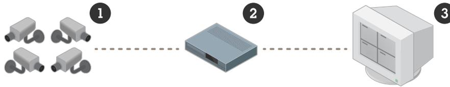
Figure 6. Ein Überwachungssystem mit analogen Kameras (1), angeschlossen an einen DVR (2) mit Quad- oder Multiplex-Funktionalität, der eine digitale Aufzeichnung ermöglicht.
