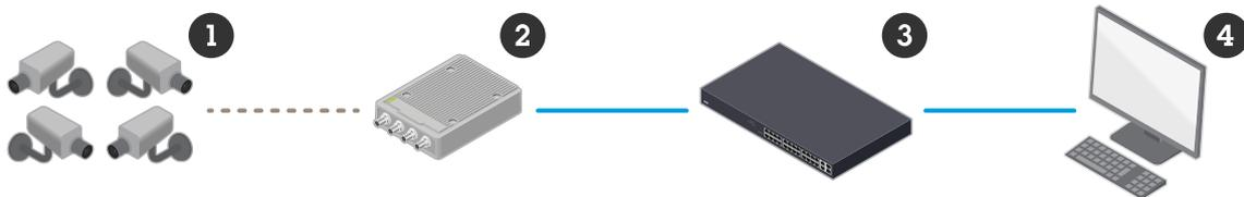
*Figure 1. Analoge Kameras (1) können über vorhandene Koaxialkabel an einen Video-Encoder (2) angeschlossen werden. Der Video-Encoder digitalisiert die Videodaten und sendet sie über ein LAN an einen Netzwerk-Switch (3), der sie zur Video Management Software (VMS) (4) weiterleiten kann.*
