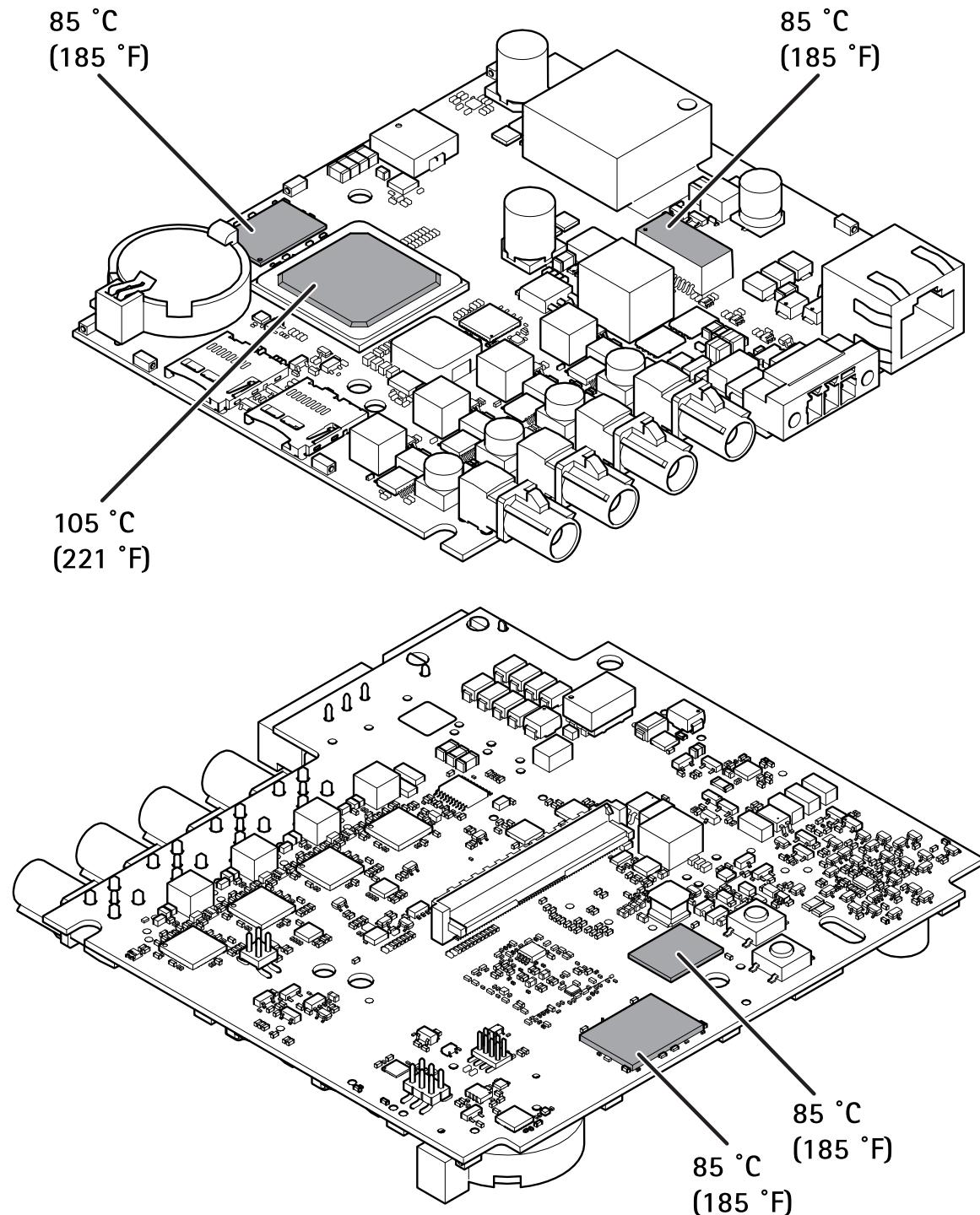
*Temperature massime consentite. Se la temperatura ambiente è di 35 °C o superiore, la temperatura dei componenti aumenta e devono essere raffreddati.*
