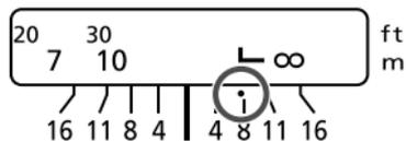
Le repère infrarouge corrige le réglage de mise au point lors de l'utilisation de films infrarouge en noir et blanc. Effectuez manuellement la mise au point sur le sujet, puis ajustez le réglage de la distance en déplaçant la bague de mise au point sur le repère infrarouge correspondant.
