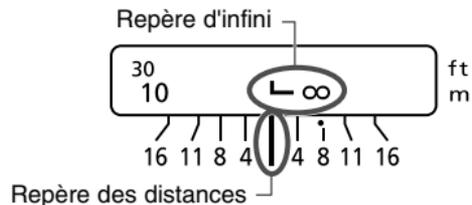
Pour corriger le décalage de mise au point lors d'une mise au point à l'infini qui pourrait résulter d'un changement de température.
