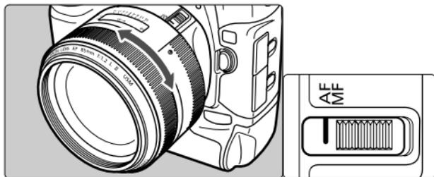
Pour effectuer des prises de vue avec mise au point automatique (AF), réglez le sélecteur de mode de mise au point sur AF. Pour une mise au point uniquement manuelle (MF), réglez-le sur MF et effectuez la mise au point en tournant la bague de mise au point.
