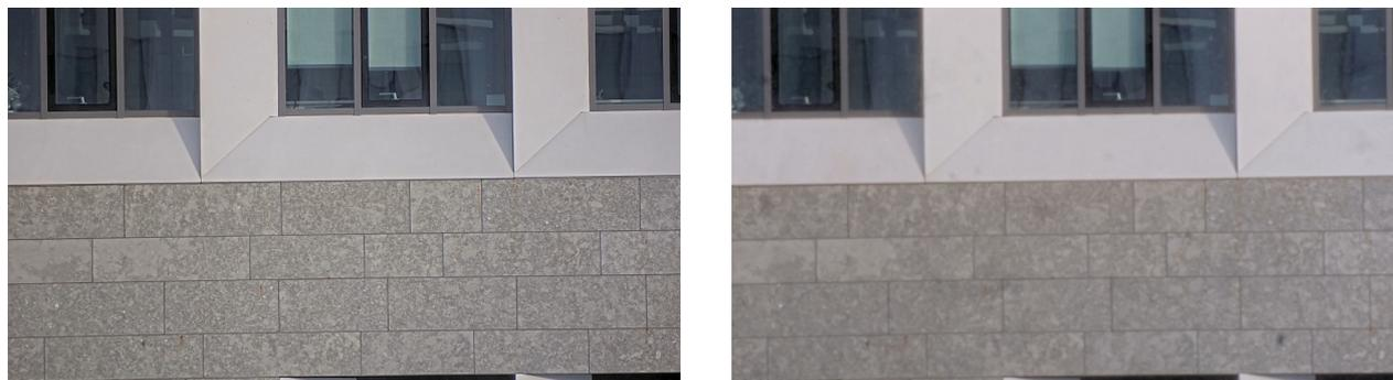
*Un diaphragme dont l'ouverture est trop faible causera un phénomène de diffraction tel qu'illustré dans l'image de droite.*
