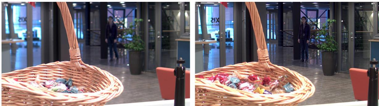
*L'image à gauche a été prise avec une caméra équipée d'un objectif à diaphragme DC. L'image à droite a été prise avec une caméra à objectif P-Iris. Elle présente une profondeur de champ plus grande que l'image de gauche.*
