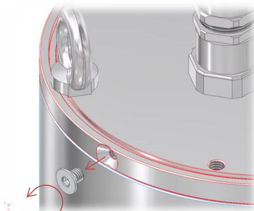
Рис. 6-5 Удаление винта с потайной головкой, тип T08-TNXCD
