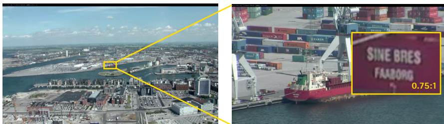
L'AXIS Q6035-E vous permet de lire des écritures à 1.6 km de distance. Sur la gauche, une capture de la vue en HDTV 1080p; sur la droite, un zoom optique 20x sur la coque d'un cargo.
