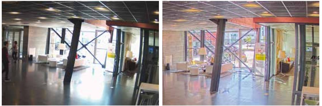
圖 5 和 6：具有強烈背光的室內場景。不具 WDR 能力 (左側) 的傳統網路攝影機，和具備鑑識 WDR 的安迅士攝影機 (右側) 之間的比較。
