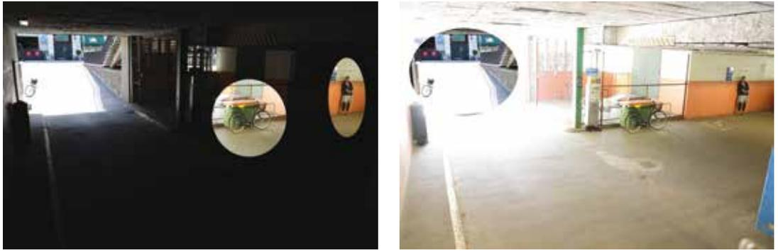
圖 3 和 4：和前面相同的場景。左側影像顯示短曝光時間漏掉的細節。右側影像顯示長曝光時間漏掉的細節。
