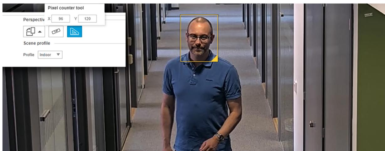
*Figure 4. Una vista della telecamera con il contatore di pixel visibile. Lo strumento indica che la cornice misura 96 pixel in larghezza: l'identificazione, che richiede almeno 40 pixel in larghezza sul volto, è quindi possibile.*
