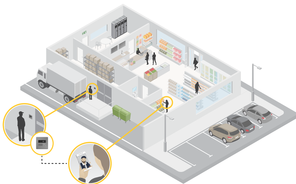
Figure 2. Typisches Sicherheitssystem für ein kleines bis mittelgroßes Unternehmen. Über das Videobild des Intercoms können die Mitarbeiter Waren annehmen oder Besuchern die Tür öffnen, ohne Kunden im Laden allein zu lassen.
